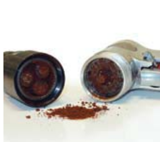
Вышедшая из строя пневматическая арматура
