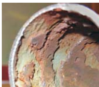
Коррозия в форме ржавчины и трубных отложений
